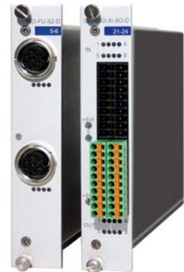
Der rechnersteuerbare Einschub DIO-8-D dient der Erfassung von bis zu 8 digitalen Eingangssignalen (High Pegel 3,5 bis 60 V, Low Pegel -30 bis + 1 V, Samplefrequenz 20 kHz) sowie der Ansteuerung von 8 Relaisausgängen (bis 2 A, 220 V). Die Eingänge sind optoentkoppelt zueinander. Die Relaisausgänge können pro Kanal mittels Jumper als Öffner oder Schließler eingestellt werden. Die Schaltzustände der Ein- und Ausgänge werden über LEDs auf der Frontplatte angezeigt.
