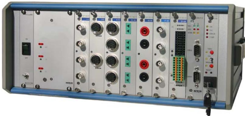
Frequenz- und digitale Signale. Die Abtastraten der Verstärker liegen bei max. 20 kHz pro Kanal. Die AD Wandlung erfolgt mit 24 Bit Auflösung. Die Messdatenausgabe erfolgt digital mit 16 Bit über die Ethernet Schnittstelle des Systems. Kalibrierdaten und die komplette Parametrierung werden im Flash-EPROM des Verstärkers gespeichert. Alle Kanäle arbeiten zeitsynchron.
