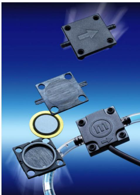
Einfach und zuverlässig: Der radikal simple Aufbau macht die Mikropumpe trotz konsequenter Miniaturisierung weitgehend resistent gegen Partikel in Pumpmedien.
