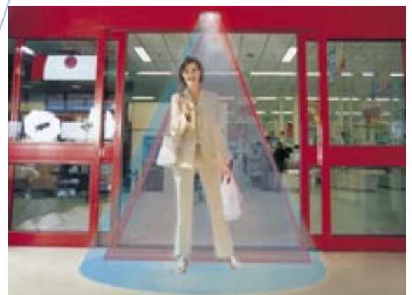
Erfassungsfelder des Radars (Neigung 27° Antenne mit breitem Feld) Absicherungsvorhang (Neigung -4° Vorderseite mit schmalem Feld) Montagehöhe: 2,20 m - Antenne mit 3 Elementen
