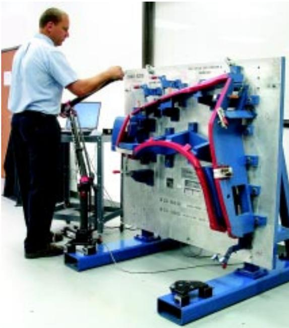
*TooLOK™ ist hervorragend geeignet zum Messen von Vorrichtungen, Werkzeugen und Teilen. Das System erkennt das vordefinierte Teil und die erforderliche Dateien und Messanweisungen werden aufgerufen.*
