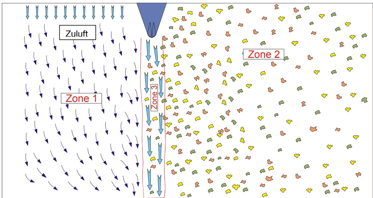
Das Luftführungssystem WIBObarrier vertical plus arbeitet nach dem 3-Zonen-Prinzip:
