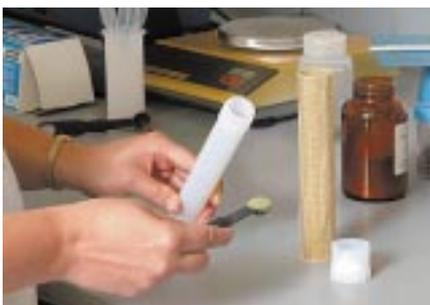
Einwaage der Probe in den Behälter
