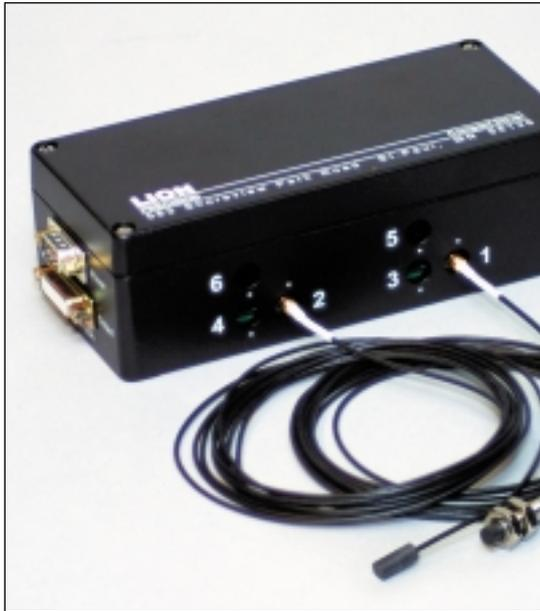
**Bis zu sechs Kanäle von Berührungslose Positionsmessgeräte:** Bei Anwendungen, die in einer einzigen Packung viele Messkanäle erfordern, wird der Treiber ECL130 benötigt.
