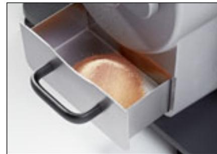
Zerkleinerung von Keramik mit der Scheibenmühle PULVERISETTE 13 premium line – Spaltweite 0,7 mm.
