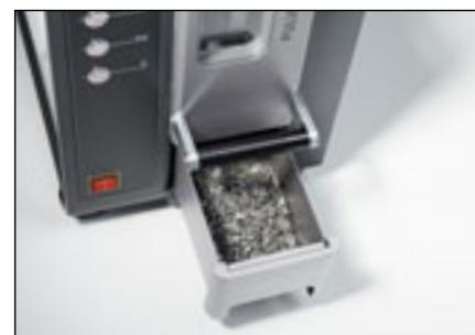
Zerkleinerung von Ferro-Legierungen mit dem Backenbrecher PULVERISETTE 1 premium line – Spaltweite 6,5 mm.
