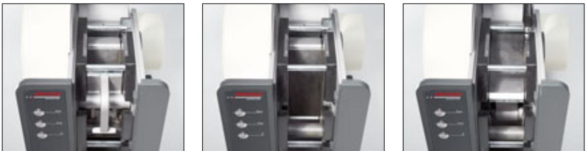
Einfache Reinigung: Feste Brechplatte entnehmen, bewegliche Brechplatte nach oben schwenken. Für einen vollständig frei zugänglichen Mahlraum.
