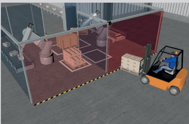
Zugangssicherungen mit zwei autarken Zellen
