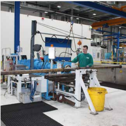
Extruder mit Stator für die Ölförderung
