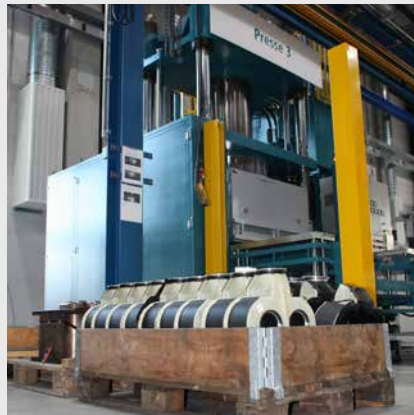
Presse mit Gehäuseeinleger für TORNADO® T2
