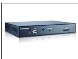
GV-IP Decoder Box Darstellung auf Monitor, über Netzwerk ohne PC
