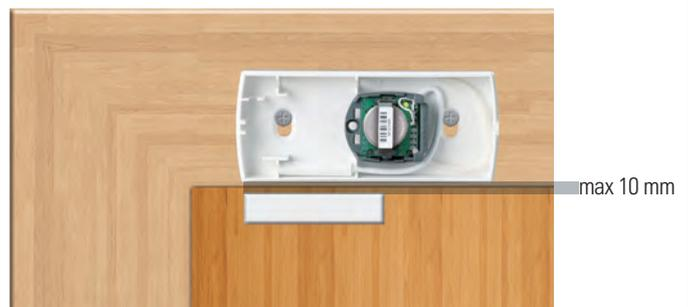
3. Das Gegenstück mit dem Rohmagneten parallel zum Reed-Kontakt montieren. **Der Abstand sollte zwischen 5 bis 10 mm betragen. Maximal jedoch 10 mm.**
