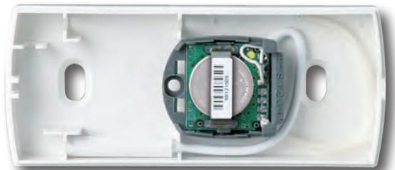
2. Die mitgelieferte Batterie CR 2032 (3 V Lithium) in den Batterieclip einschieben.
