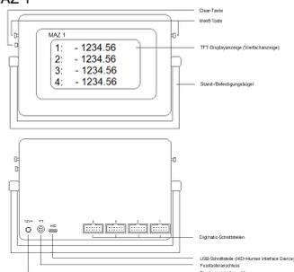
Abmessungen: 121mm x 34mm x 181mm (H x T x B) ohne Bügel
