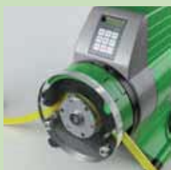
Hebel herunterdrücken, um den Schlauchsattel fest zu ziehen
