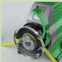
Schlauchsattel beidseitig an den entsprechenden Stiften fixieren
