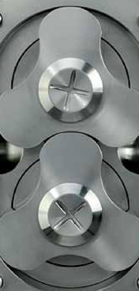
Multilobe-Rotor der Rotationskolbenpumpe *Revolution*
