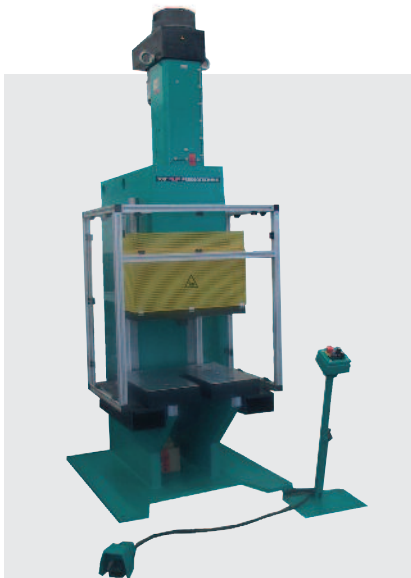
TOX®-Presse Baureihe PC mit 2-Säulen geführter Stößelplatte, für ziehenden und drückenden Betrieb, EPMK 400 mit Bremse, Sicherheitssteuerung mit Funktion "Sichere Geschwindigkeit", Hubauslösung über 1-Hand-Taster oder Fußtaster
