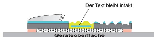
Wenn jemand versucht, die Plakette zu entfernen, bleibt der eingelassene Text geschützt und am Gerät haften.
