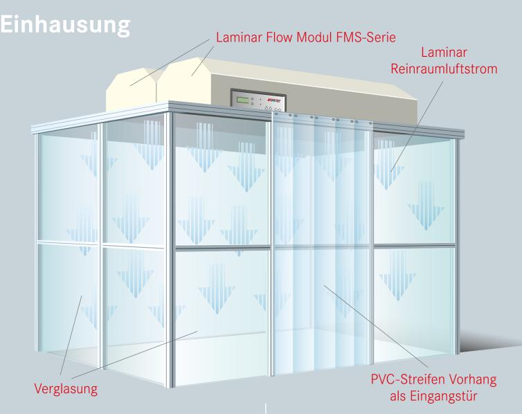
Mit dem Spetec Reinraumsystem können auch komplette Einhausungen vorgenommen werden. Die Zellen werden durch die verschiedenen Einzelelemente an kundenspezifische Bedürfnisse angepasst z.B.
