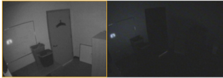
Illustra PoE-IR-Beleuchtung: links Aufnahme mit aktivierter IR-Beleuchtung, rechts ohne
