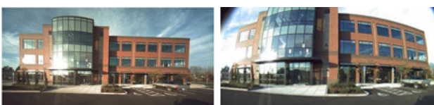
Illustra 600-Weitwinkelobjektiv (links) im Vergleich zu herkömmlichem Objektiv mit „tonnenförmiger“ Verzerrung
