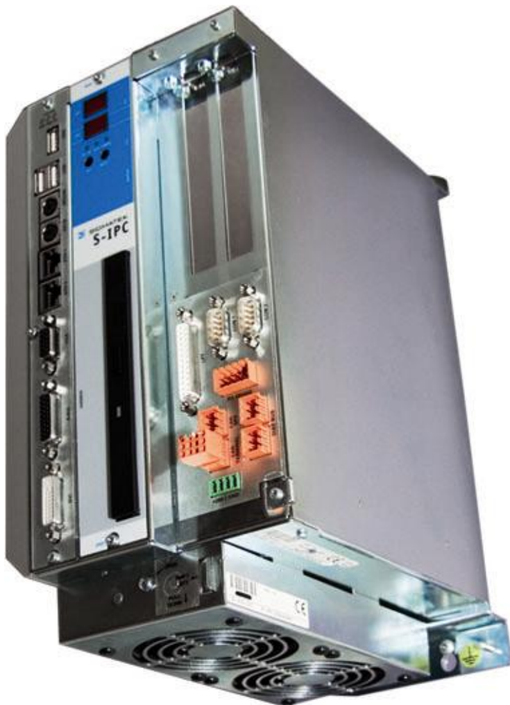
S-IPC mit Kühlkörper und Lüfter
