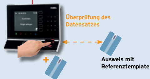
Das Verifikationsverfahren - 1 : 1 Vergleich der Fingerprintdaten
