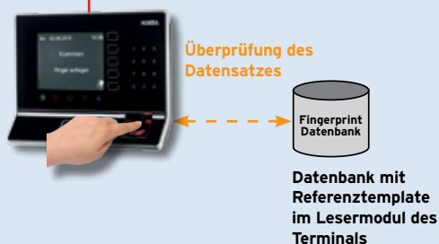
Das Identifikationsverfahren - 1 : n Vergleich der Fingerprintdaten
