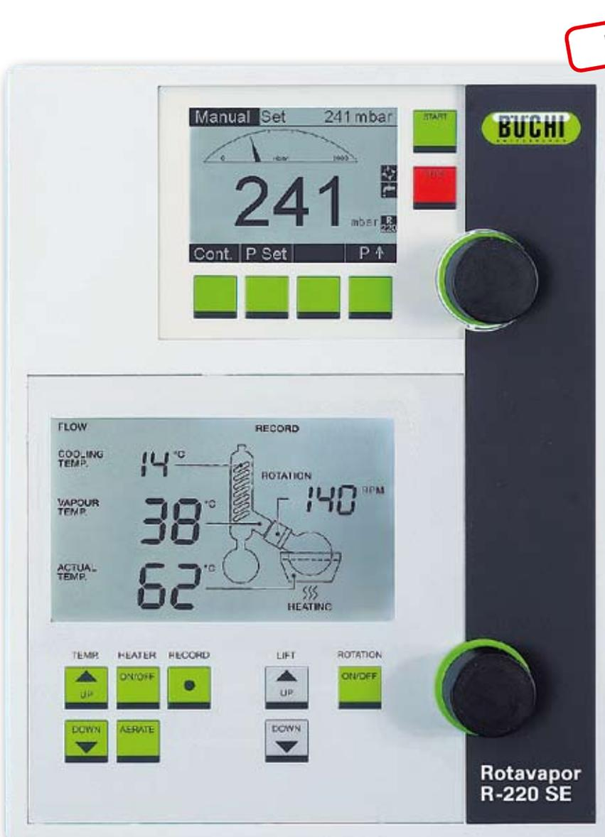
**Das grosse und übersichtliche Display ermöglicht die Überwachung des Prozesses auf einen Blick. Alle Parameter und Betriebszustände sind gut lesbar angezeigt. Dies sind:**
