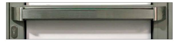
Die zeitlos elegante mechanische e-Bar® ist ein Panikstangenbeschlag aus Edelstahl. Sie wird in drei verschiedenen Längen ausgeliefert, die vor Ort individuell gekürzt und somit jeder Tür optimal angepasst werden können. Die Druckstange wird quer über die gesamte Türbreite montiert und entspricht so auch den gesetzlichen Bestimmungen, die eine Anbringung über mindestens 60 % der Türbreite vorgeben.
