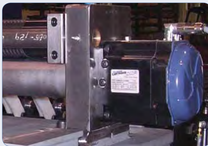
Dieselbe Maschine mit einem Cartridge DDR-Antrieb. Hier ist die Welle der angetriebenen Walze in den Cartridge DDR-Antrieb verlängert, und das Antriebsdrehmoment wirkt direkt an der Mechanik.
