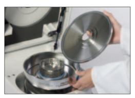
Besonders zeitsparend: **schneller Wechsel aller Mahlteile** ohne Werkzeug in wenigen Handgriffen zur einfachen Reinigung außerhalb des Gerätes.
