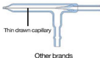
Bei einigen Marken von konzentrischen Glas-Zerstäubern ist der Probenkanal als ausgezogenes Kapillarrohr ausgeführt. Diese Ausführung bringt die folgenden Probleme mit sich:
