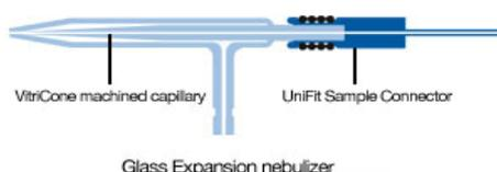
Alle konzentrischen Glas-Zerstäuber von Glass Expansion weisen dieselbe einzigartige VitriCone-Bauweise für den Probenkanal auf. Bei der VitriCone-Bauweise ist der Probenkanal aus einer schweren Glaskapillare gefertigt, die mit sehr engen Toleranzen bearbeitet ist. Die Vorzüge der VitriCone-Bauweise sind:
