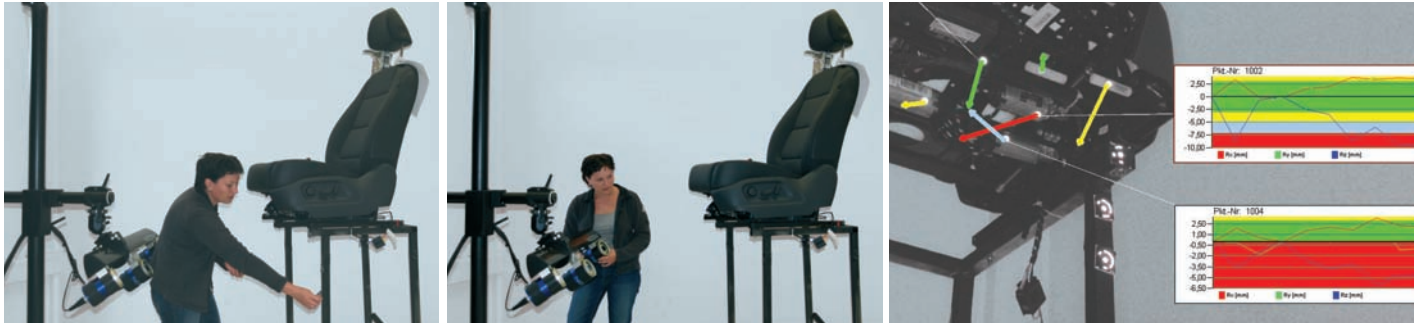
Versuchsdurchführung am Beispiel Sitzvermessung: Kameramontage, Signalisierung mit Punktmarken, Messung, Ergebnisreport
