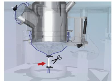
Für die Befüllung von Gebinde ohne Inliner (z.B. Container) wird ein Adapter mit Schutzfolien-schlauch an dem Gebinde angebracht.
