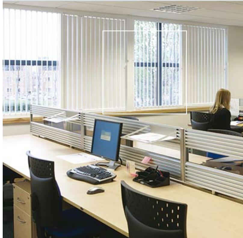
Die Funktionsweise: Sind auf den Fensterflächen zusätzliche PROFILON® Sicherheitsfolien aufgebracht, schließt sich das BLINDGARD®-System bei einer Explosion blitzschnell automatisch und verhindert so das Eindringen von herumfliegendem Glassplittern und anderen Teilen, wie z.B. Teile von Fahrzeugen oder Fassadenteilen.
