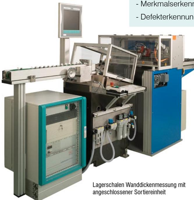
Lagerschalen Wanddickenmessung mit angeschlossener Sortiereinheit
