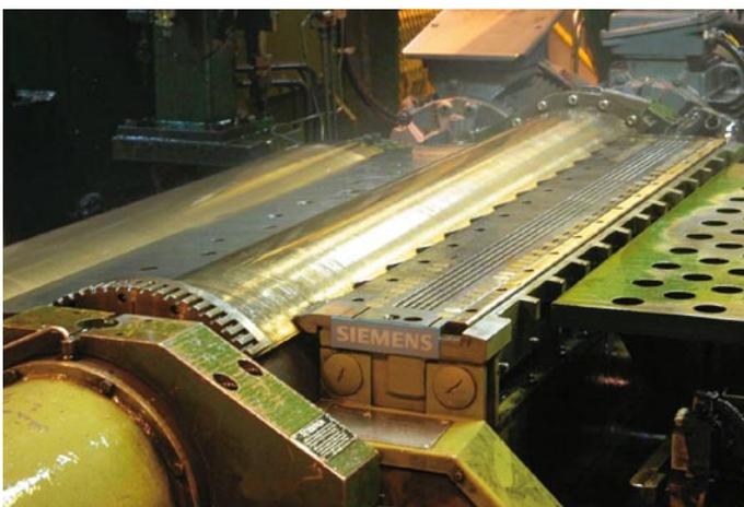
Micro-Epsilon Sensoren zur Planheitsmessung im Walzwerk (Foto: Siemens)
