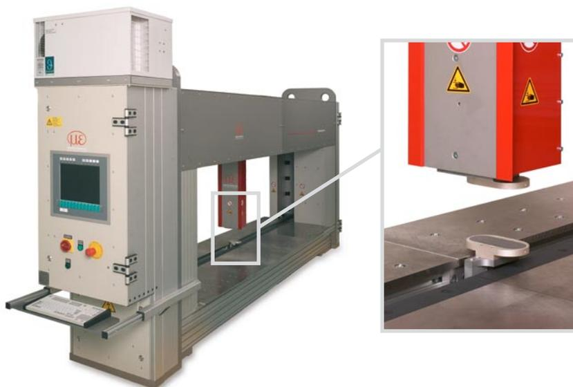
Die Dickenmessung erfolgt mit kapazitiver Sensorik: der traversierende Messarm fährt die Messstrecke ab und liefert konstant stabile Messergebnisse, ohne das Messobjekt zu berühren. Ein weiterer entscheidender Vorteil: keinerlei Strahlenschutzbestimmungen wie etwa bei isotopischen Verfahren sind einzuhalten.
