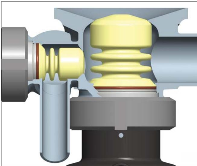
Schnittdarstellung VESTA® Tankbodenventil mit zusätzlichem CIP/SIP-Ventil
