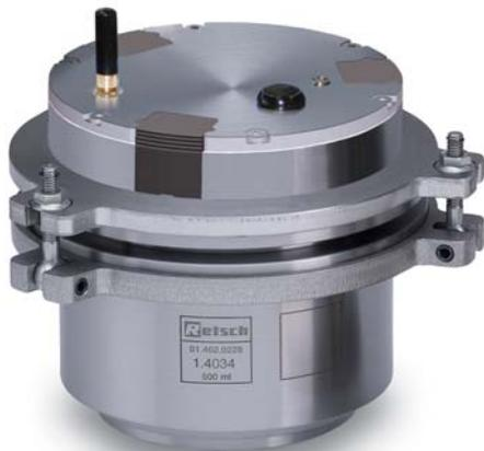
Um Prozesse, die beim Vermahlen in Kugelmühlen ablaufen (z.B. chemische Reaktionen oder Phasenübergänge) verstehen zu können, ist es sinnvoll, die wichtigsten thermodynamischen Größen – Druck und Temperatur – aufzuzeichnen.
