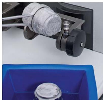
Die Mahlbecher werden vor der Vermahlung im Kryokit für ca. 2 - 3 Minuten in flüssigen Stickstoff (-196 °C) getaucht
