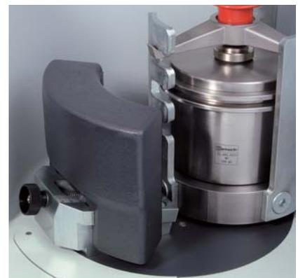
Zur optimalen Auswuchtung lässt sich das Gegengewicht der PM 100 auf einer schrägen Führungsschiene einstellen
