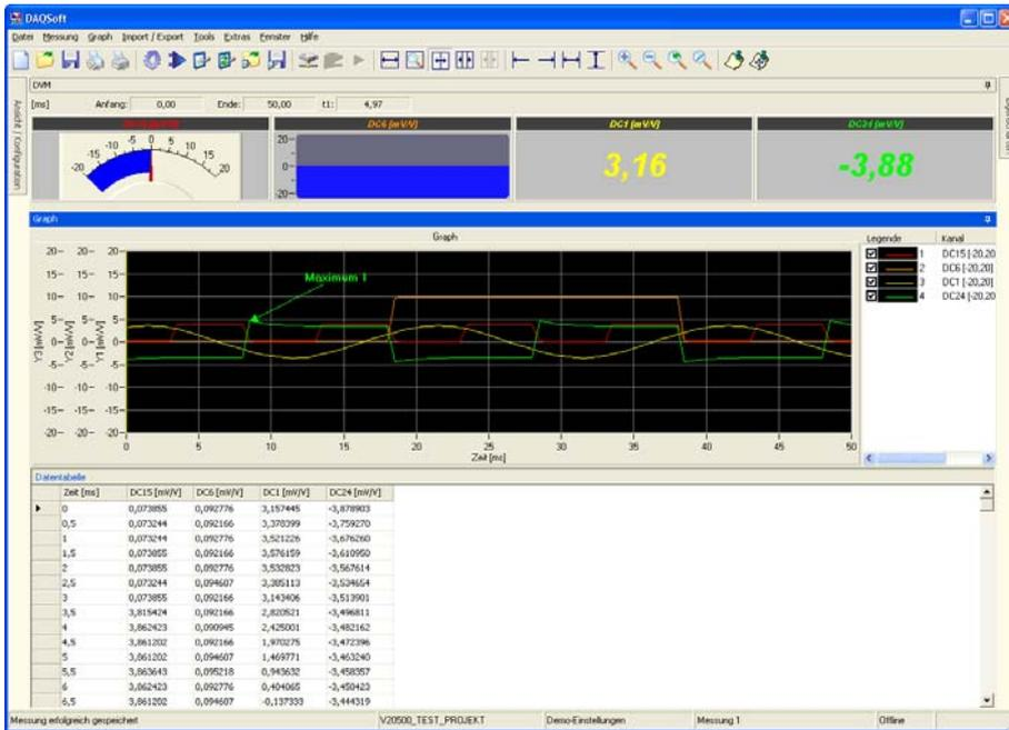
Im Offline Betrieb lassen sich Minima und Maxima auswerten und als Anmerkung dokumentieren. Parallel zur numerischen und grafischen Darstellung der Messdaten ist die Visualisierung auch in tabellarischer Form möglich.
