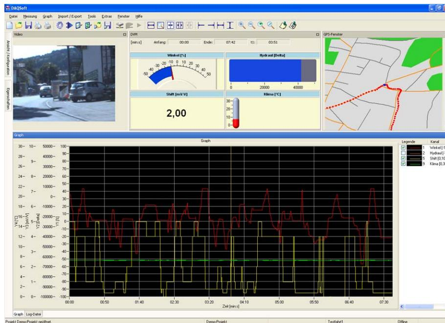
Eine erweiterte Version von DAQSoft zeichnet in Verbindung mit passender Hardware auch GPS- und Video-Daten zeitsynchron mit z.B. anderen Fahrzeug-Messdaten auf. Damit ist eine optische und räumliche Zuordnung von Ereignissen möglich. Video-Daten werden z.B. auch nur stationär zur Korrelation von Ereignissen in einem Prüfstand erfasst.
