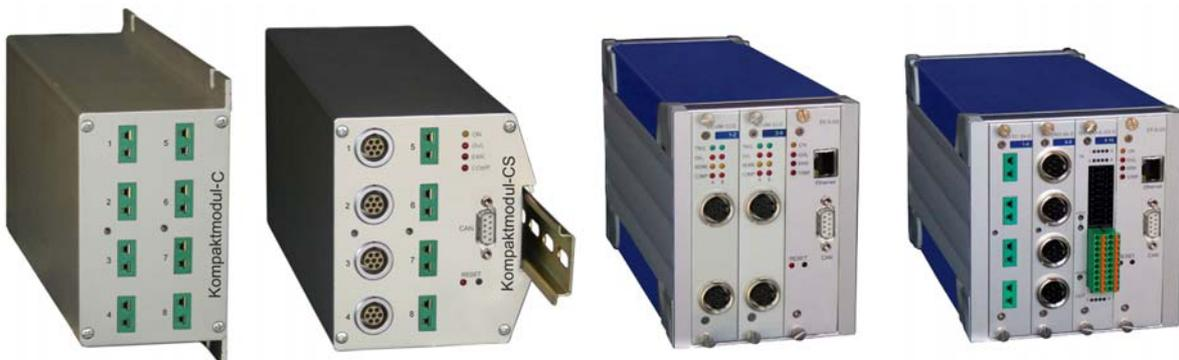
Die Kompakt-Module gibt es in 2 Varianten: 8 Kanäle (optional 16 bei TC) mit CAN-Ausgang auf der Rückseite, oder 8 (16) Kanäle mit CAN-Ausgang auf der Frontseite und RS 232 auf der Rückseite. Die Verstärkertypen sind beliebig wählbar, aber ab Werk fest eingebaut. Gehäuseausführungen sind Flansch, Hutschiene, oder Box.
