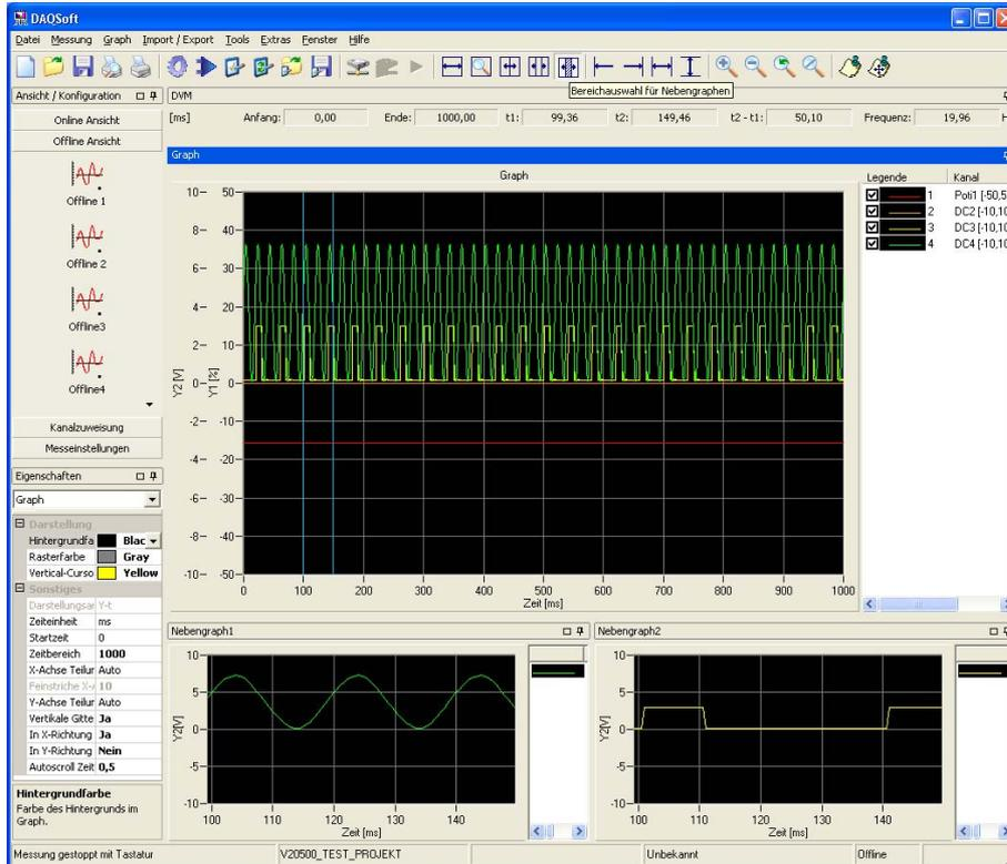
Es können nicht nur alle Kanäle zusammen in einem Hauptgraph, sondern auch einzeln oder gruppiert in Nebengraphen dargestellt werden. Für eine höhere Auflösung ist eine zum Hauptgraph unterschiedliche Zeitbasis wählbar, die Y-Achse ist jedoch gleich. Die Darstellung ist Online und Offline möglich.
