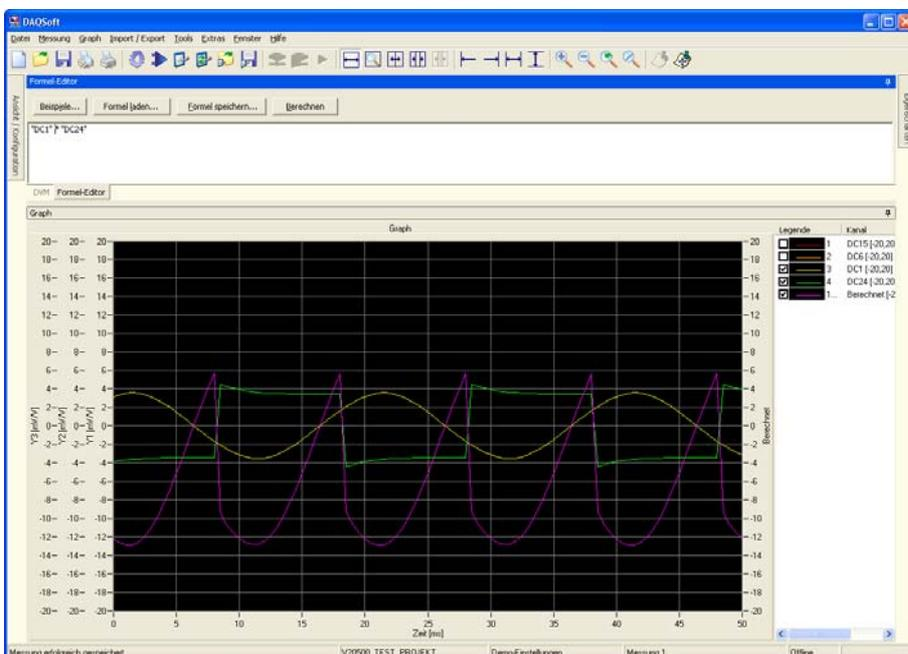
Neben dem Vergleich von Messkurven ist auch die Verknüpfung und eine nachträgliche mathematische Bearbeitung von Messkanälen möglich. Ebenso kann eine nachträgliche Filterung von Messkanälen sowie Analysen wie FFT oder Leistungsspektrum vorgenommen werden.
