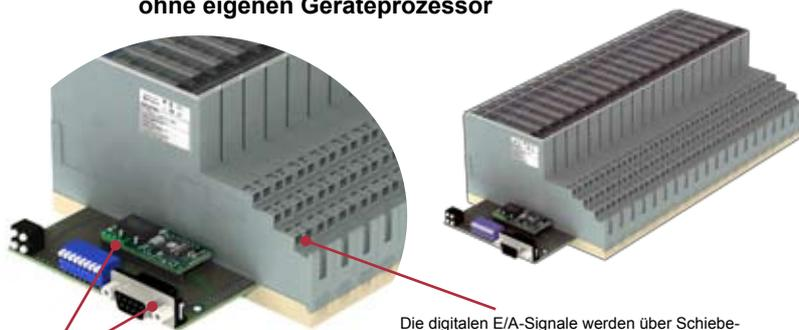
Zusätzlich zum Anybus-IC werden lediglich eine 5-Volt-Versorgung, der Stecker für den Busanschluss sowie Adress-Schalter, Diagnose-LEDs und die Leistungselektronik zur Ansteuerung der E/A-Signale benötigt.
