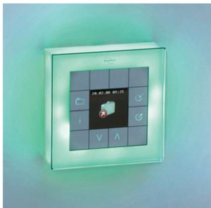
DT 200 mit polierter Glasoberfläche sowie mit sechs frei programmierbaren Sensortasten. Hier mit dem Icon für "Dienstgang Gehen" und grün beleuchtetem Display.
