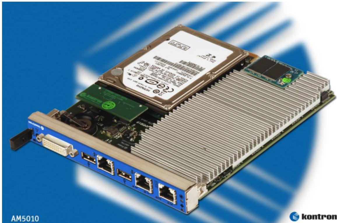
**Eching/Nürnberg, Deutschland, 26. Februar 2008** – Das Kontron AM5010, das heute auf der Embedded World vorgestellt wurde (Halle 12 / Stand 404), ist das weltweit erste AdvancedMC (AMC), das alle bei Single Board Computern (SBC) üblichen Funktionen integriert.
