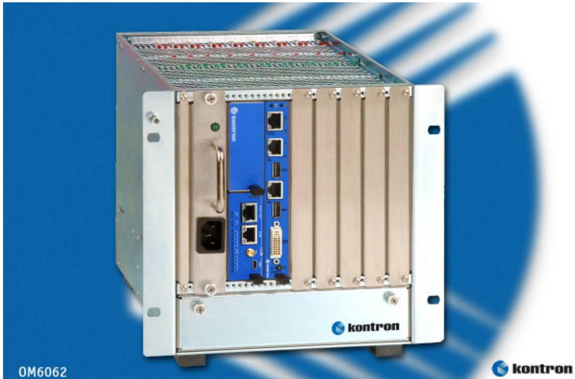
**Eching/Nürnberg, 26. Februar 2008** – Die auf Basis von Double-width AdvancedMC Modulen entwickelte integrierte Plattform Kontron OM6062, die heute zur Embedded World vorgestellt wurde (Halle 12, Stand 404), ist Kontron's erste, für industrielle Applikationen kostenoptimierte MicroTCA Plattform. Sie bietet Platz für bis zu sechs AdvancedMC Module.
