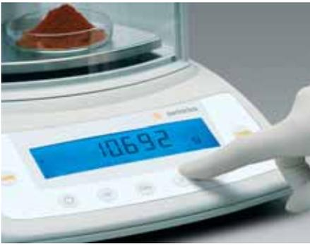
Der deutliche Druckpunkt bei allen Tasten sorgt für eine eindeutige Funktionsauslösung und gibt Sicherheit im Wägeprozess.
