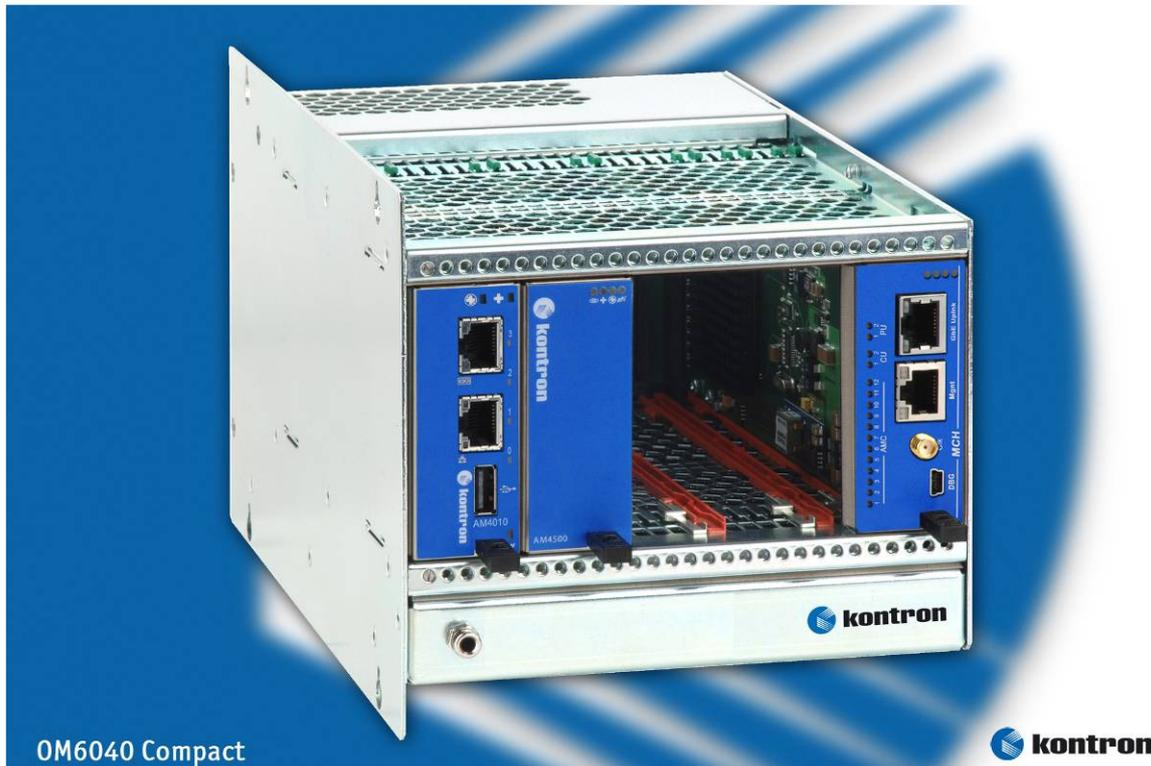
**Eching/Nürnberg, 28. November 2007** – Kontron (SPS/IPC/DRIVES Halle 7 / Stand 306) stellt mit dem Kontron OM6040 System, eine kompakte und modulare MicroTCA Plattform vor. Das neue Kontron OM6040 ist ideal, um kleine, kompakte und hoch integrierte Multiprozessorsysteme basierend auf PCI Express (PCIe) oder Gigabit Ethernet (GbE) Packet Switching Backplanes zu entwickeln.
