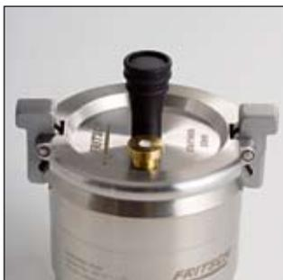
Alle Standarddeckel sind mit einem Entlüftungsventil ausgestattet. Ein eventueller Überdruck im Mahlbecher wird kontrolliert ausgeglichen. Der Mahlbecher kann einfach und sicher geöffnet werden.
