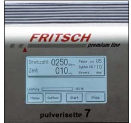
**Besonders praktisch:** Der übersichtliche Touchscreen der PULVERISETTE 7 ist mit einem Handgriff verstellbar und lässt sich so ganz leicht an jede Aufstellungssituation anpassen.
