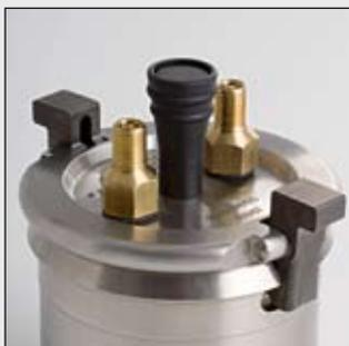
Die *premium line*-Begasungsdeckel erlauben das Mahlen unter Schutzgas und mechanisches Legieren – schnell und sicher in der Funktion.
