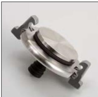
Durch einen fixierten O-Ring im Deckel schließen die *premium line*-Mahlbecher so dicht, dass auch die Mahlung in Suspension ohne Zusatzdichtung ganz problemlos möglich ist.
