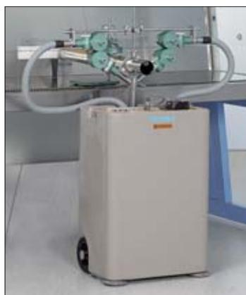
Vor-Ort-Prüfung des Personenschutzes mittels KI-Diskus-Test.
