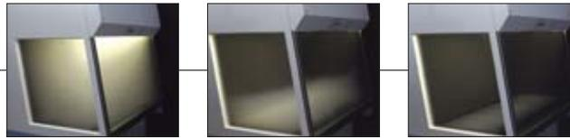
0 Partikel werden schnell aus dem Arbeitsraum beseitigt.  $t = 2,2 \text{ sec}$
