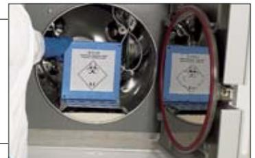
**Sichere und unkomplizierte Dekontamination im Autoklaven.**
