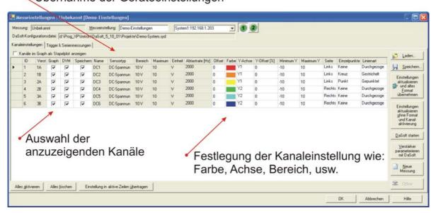
Die mit DaSoft eingestellten Parameter werden automatisch in DAQSoft übernommen. Hier können jetzt die anzuzeigenden bzw. zu speichernden Kanäle bestimmt, sowie Kanaleinstellungen für die graphische Darstellung wie Farbe, Achse und Skala festgelegt werden.
