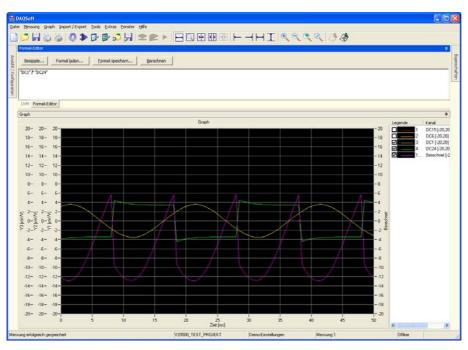
Neben dem Vergleich von Messkurven ist auch die Verknüpfung und nachträgliche mathematische Bearbeitung von Messkanälen möglich. Ebenso kann eine nachträgliche Filterung von Messkanälen sowie Analysen wie FFT oder Leistungsspektrum vorgenommen werden.
