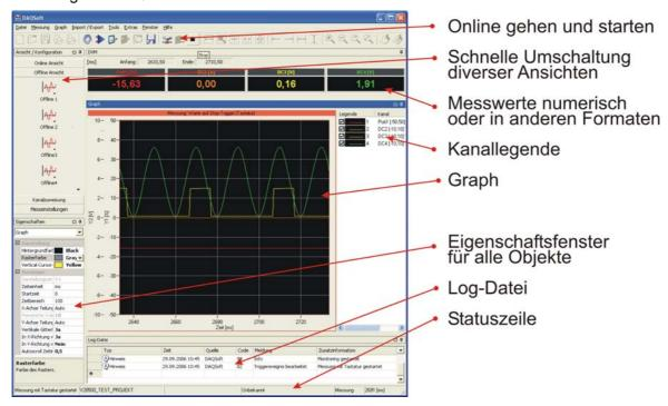
Mit der Aktivierung der TCP/IP Verbindung und Betätigen des Start-Knopfs wird die Messung gestartet. Die ausgewählten Kanäle werden automatisch angezeigt. Die andockbaren Fenster für Ansichten, Messwerte, Graph, Eigenschaften, Log, usw. können beliebig angeordnet bzw. ein- und ausgeblendet werden.
