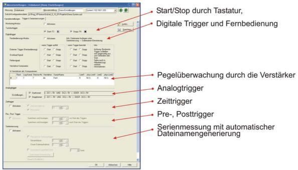
Neben der im Verstärker einstellbaren Schwellenwerte können auch mit DAQSoft weitere Triggerbedingungen und Verknüpfungen für digitale und analoge Werte, sowie Zeittrigger und Parameter für periodische bzw. Serienmessungen eingerichtet werden.
