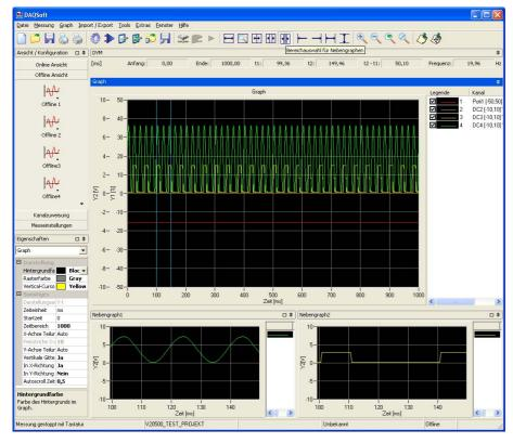
Es können nicht nur alle Kanäle zusammen in einem Hauptgraphen, sondern auch einzeln oder gruppiert in Nebengraphen dargestellt werden. Für eine höhere Auflösung ist eine zum Hauptgraphen unterschiedliche Zeitbasis wählbar, die Y-Achse ist jedoch gleich. Die Darstellung ist Online und Offline möglich.
