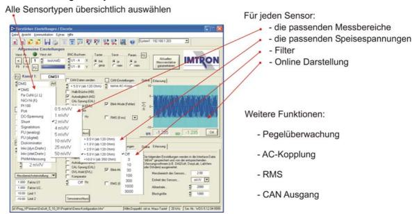
Die Parametrierung wird kanalweise oder tabellarisch mit DaSoft vorgenommen. Nach der Auswahl des entsprechenden Sensortyps erfolgt die Einstellung des Messbereichs, und ggf. der Speisespannung sowie der Filterfrequenz. Die Überprüfung des Signals erfolgt in der Online Darstellung.
