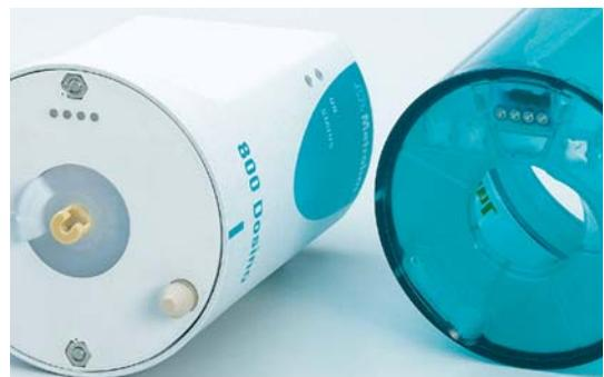
Über die vier Kontaktstifte auf der Unterseite der Dosiereinheit 807 (rechts) übernimmt der Titrande die im Datenchip gespeicherten Informationen.
