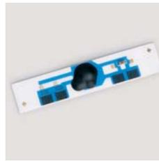
Mehr Intelligenz: Der Datenchip der Dosiereinheit enthält alle wichtigen Titriermitteldaten.
