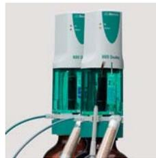
Der Titrand 841 arbeitet mit Dosiereinheiten, die sich optimal für das Handling der KF Reagenzien eignen.
