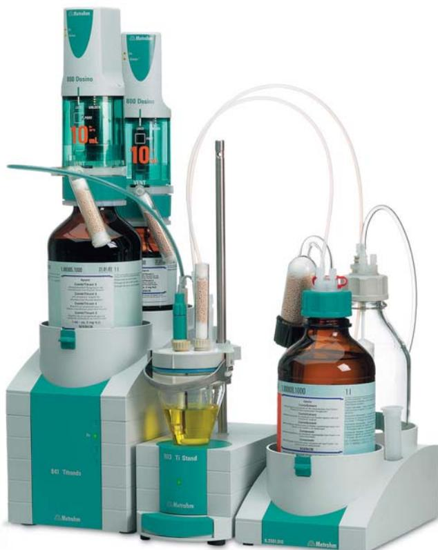
KF-Titration mit Titrando 841 und KF-Titrierstand 803. Der «Reagent Organizer» nimmt die Solvent- und die Abfallflasche auf.
