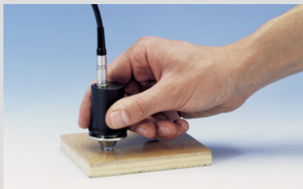
Messung der Dicke eines Lack-Zweischichtsystems auf Holz
