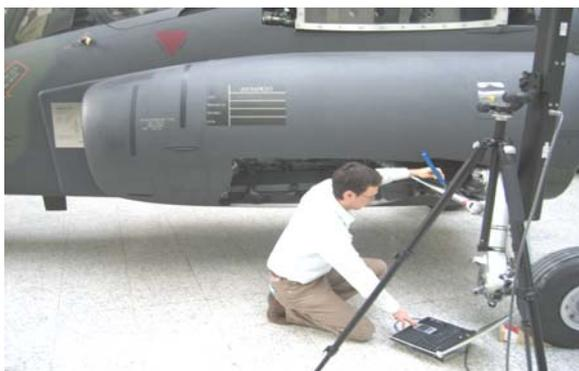
3D Creator (800mm) bei Flugzeugvermessung
