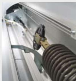
Seitenteile mit an Scharnieren montierten Deckeln sorgen für leichte und schnelle Zugänglichkeit bei Service- und Wartungsarbeiten.
