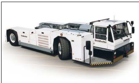
AST-1: Großer Flugzeugschlepper für Flugzeuggewichte bis zu 425 t MTOW für Flugzeug-Baumuster von A300 / B767 bis zu B747
