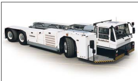
AST-1 X: Größter Flugzeugschlepper für Flugzeuggewichte bis zu 600 t MTOW für Flugzeug-Baumuster von A300 bis zu A380
