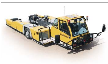
AST-3: Kleiner Flugzeugschlepper für Flugzeuggewichte bis zu 160 t bzw. 220 t MTOW für Flugzeug-Baumuster von AVRO RJ70 bis zu B767-400
