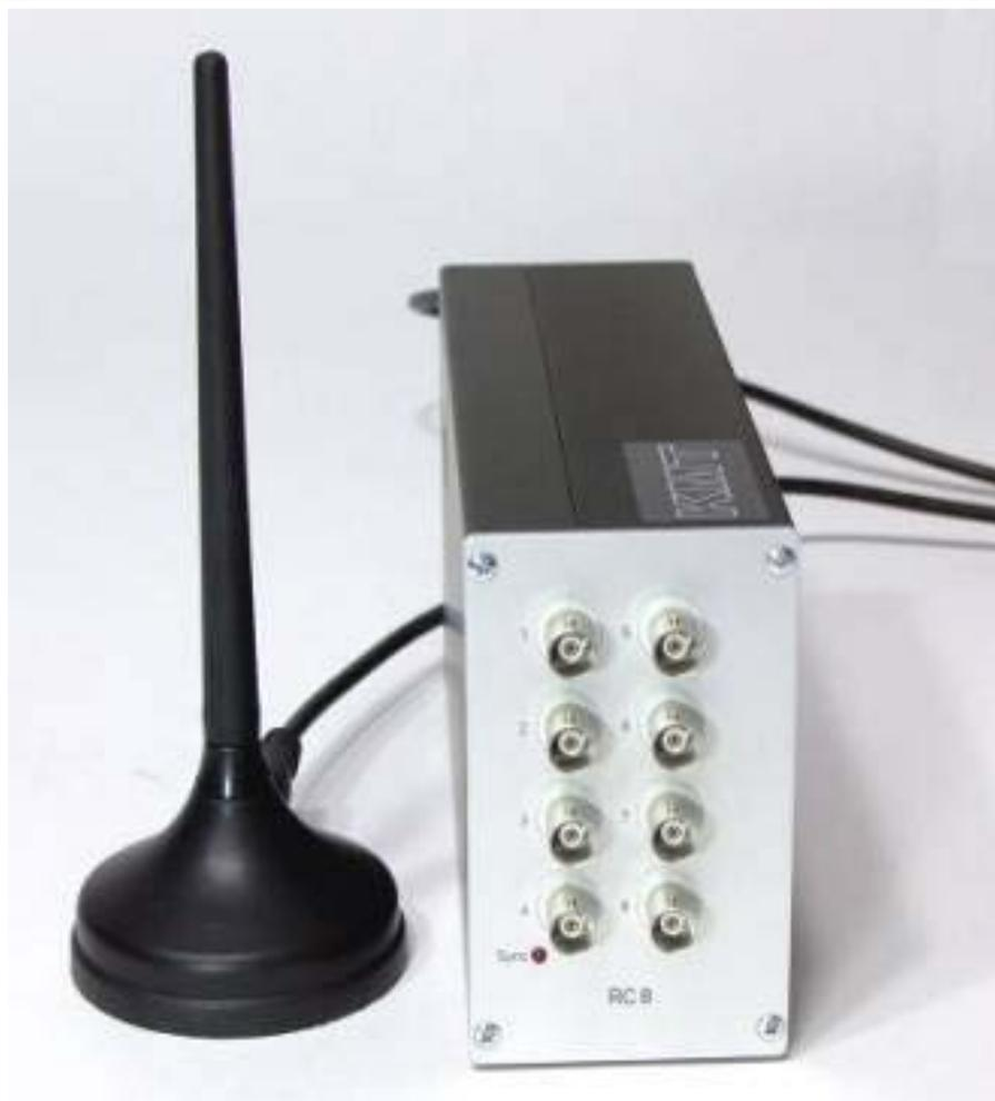
8 Kanal Decoder mit Empfangsantenne
