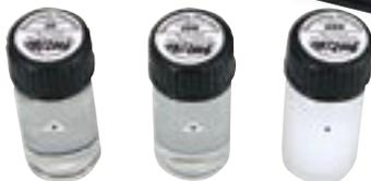
Die Trübung wird gemäß ISO 7027 nephelometrisch (90° Streulicht) bestimmt. Die Infrarot-Lichtquelle gestattet die Vermessung von farblosen sowie gefärbten Proben.
