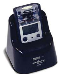
GasBadge® Datalink für die Übertragung des Ereignisprotokolls an PC oder Drucker
